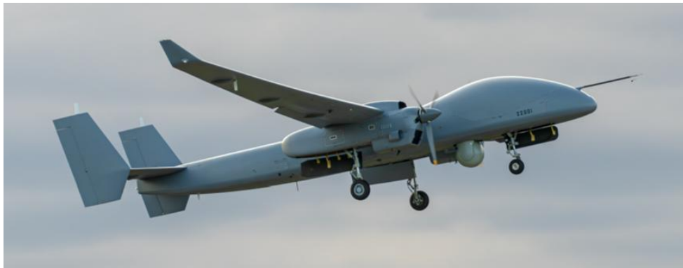
图 云龙-3 中高空长航时固定翼无人机系统
