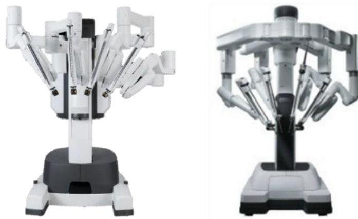
直觉外科达芬奇 Si 和 Xi 手术系统（多孔）患者手术平台布局示意图
