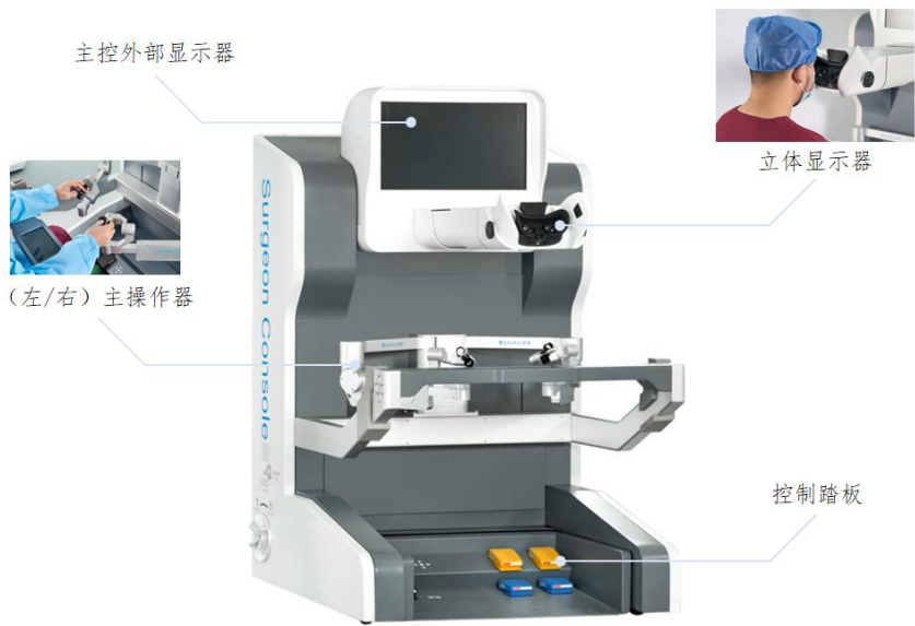
胸腹腔内窥镜单孔手术系统（SR-ENS-600）医生控制台示意图
