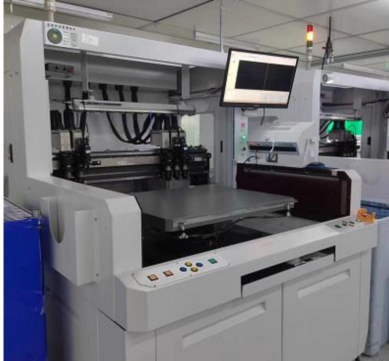
TFT 基板切割设备图示
