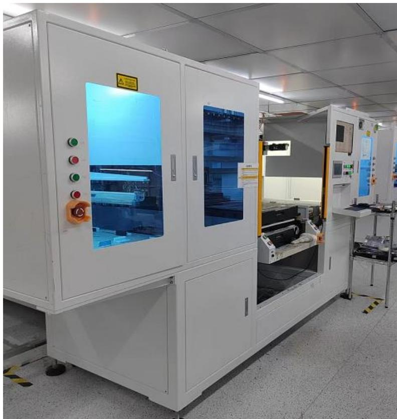
电子纸膜片切割设备图示
