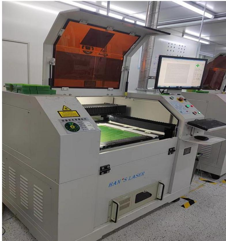
阻水保护膜切割设备图示
