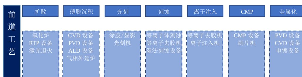
集成电路前道制造工艺流程主要设备
