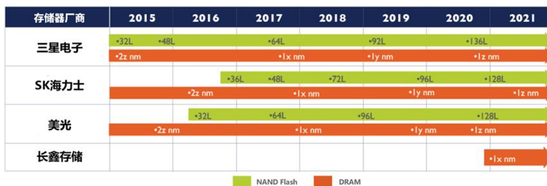
图：全球前三大存储器厂商及长鑫存储技术演进图
