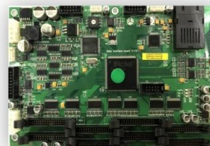
针对京瓷喷头开发的打印控制卡
