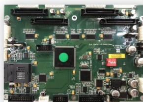
针对理光喷头开发的打印控制卡
