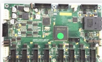
针对北极星喷头开发的打印控制卡
