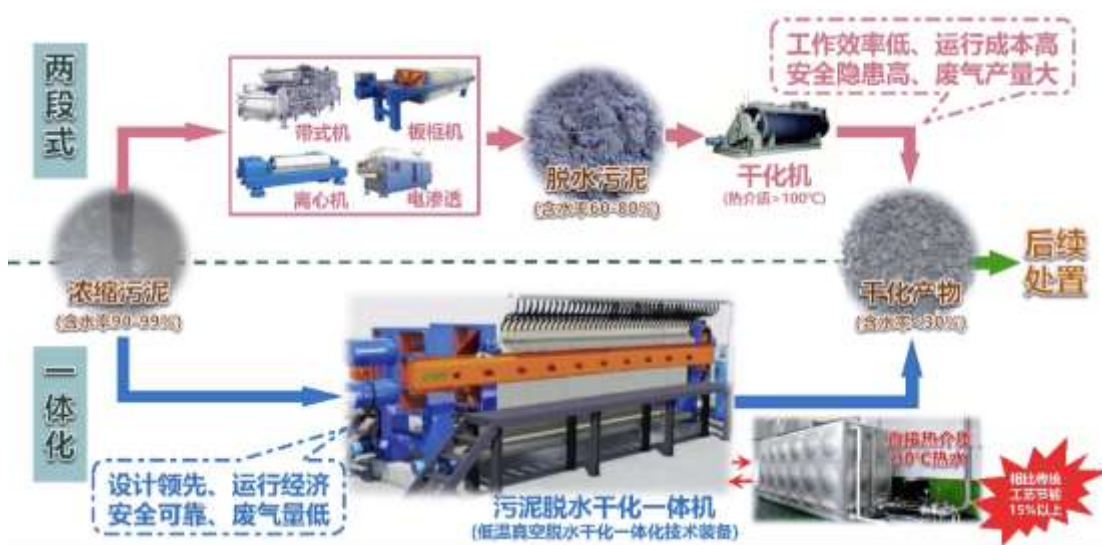
污泥脱水干化“两段式”与低温真空“一体化”工艺对比示意图
