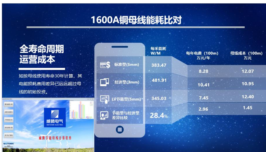
图 1：威腾电气节能母线计算软件
