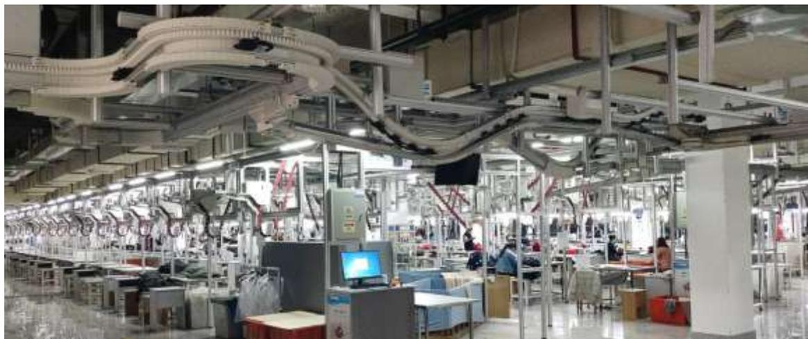
最简单的智能悬挂生产系统包含几十个工位，支持一个小型缝制小组。主要由一台主电脑服务器、一台电子看板（实时监控）、一套悬挂式自动传输系统和多个工控电脑终端机工作站组成。
