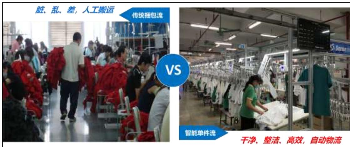
与传统捆包式（即把前道工序缝制好的半成品扎捆打包后人工传递到下一个工序）生产模式（捆包流）相比，智能悬挂生产系统生产模式（智能单件流）能够实现以下优点：
