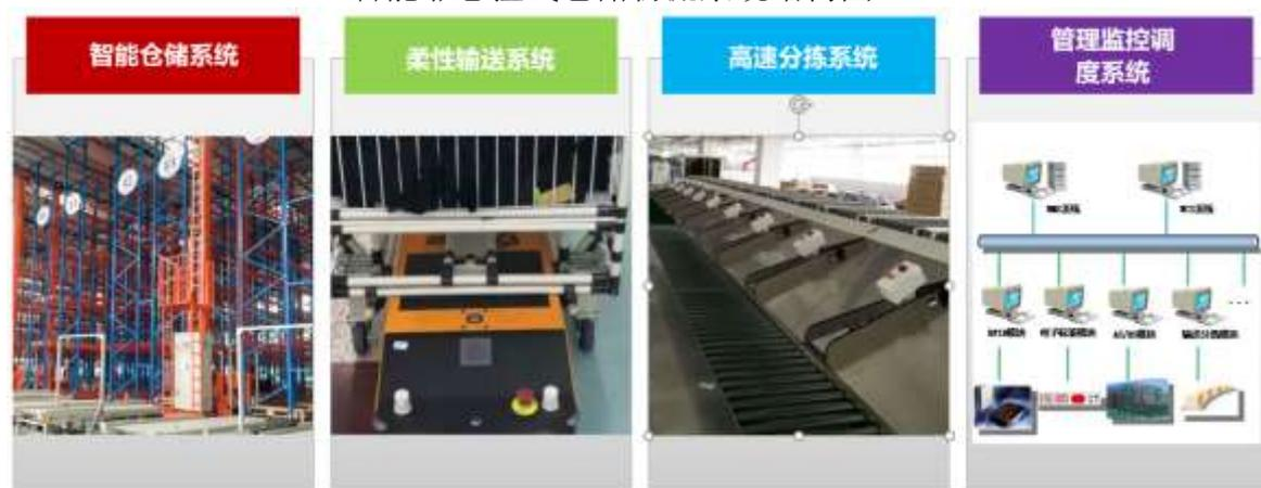
仓储系统向上联接物流系统的调度计算机，接受物料输送的指令，向下联接输送设备实现底层设备的驱动、检测与识别，完成物料输送及过程控制信息的传递，实现仓库的信息自动化、精细化管理。
