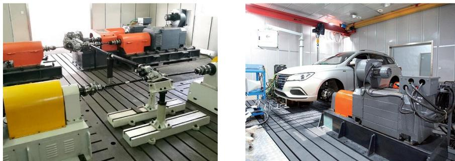
注：左图为公司的变速箱及动力总成测试台架；右图为公司的新能源汽车整车能量流性能测试验证服务
