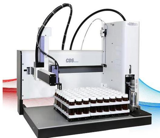
该平台采用步进电机及控制器，移动速度 0.3 米/秒，定位精度 0.3mm 以下。该平台采用电动机械爪，可抓取 0.3kg 的物品。运动平台性能指标达到国内外主流厂家水平，固相萃取技术、凝胶净化技术、顶空技术、吹扫捕集技术、热裂解技术、热解吸技术均可应用在该平台中。公司的全自动固相萃取仪 Sepline-S、全自动凝胶净化色谱仪器 Autoclean、全自动吹扫捕集仪器 CDS7350/7450，全自动热解吸仪 CDS7550S 等均采用了该平台。
