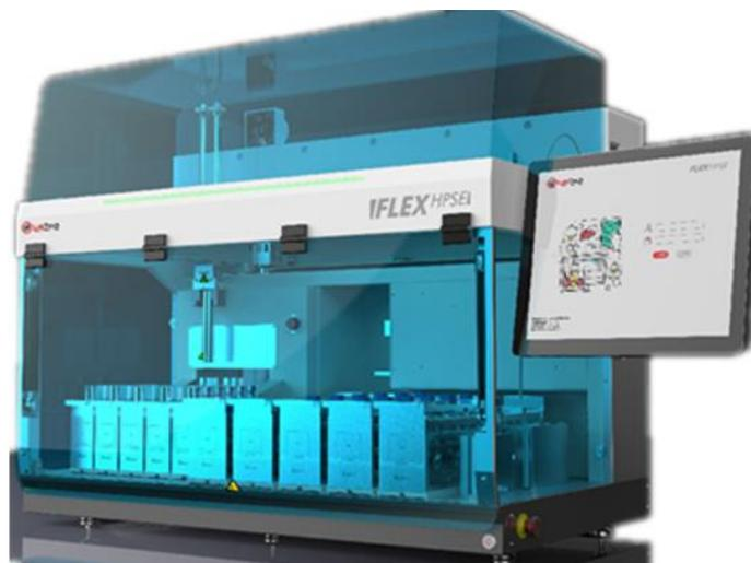
全自动高效快速溶剂萃取仪采用双通道并行设计，可同时萃取两个样品，运行效率是单通道的两倍。可连续萃取 30 位样品，XYZ 三维机械臂设计，样品可随时添加或取出，实验操作更加灵活，减少填罐和收集等待的时间。多种不同的萃取罐和收集瓶搭配可用，与平行浓缩仪及旋转蒸发仪的样品瓶通用，无需转移样品，直接进行后续浓缩操作。平台采用封闭平台式设计，自带通风系统，避免实验人员与有害试剂直接接触，可实时观测仪器的运行状态。
