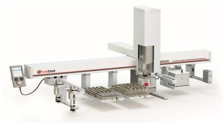
Astation 多功能样品前处理及进样平台可全自动完成复杂的液体处理、样品瓶移取、萃取柱移取等操作。可与固相萃取、微型凝胶渗析萃取净化、静态顶空、吹扫捕集、动态顶空等模块搭配使用。该平台可直接安装于气相色谱质谱仪上，并在样品处理完成后向气相色谱进样口直接上样。广泛用于各种物质中挥发-半挥发性有机化合物的全自动连续检测。平台中公司自主开发的微凝胶净化色谱模块 microGPC，能与微固相萃取 microSPE 模块联用，广泛应用于农药残留检测领域。
