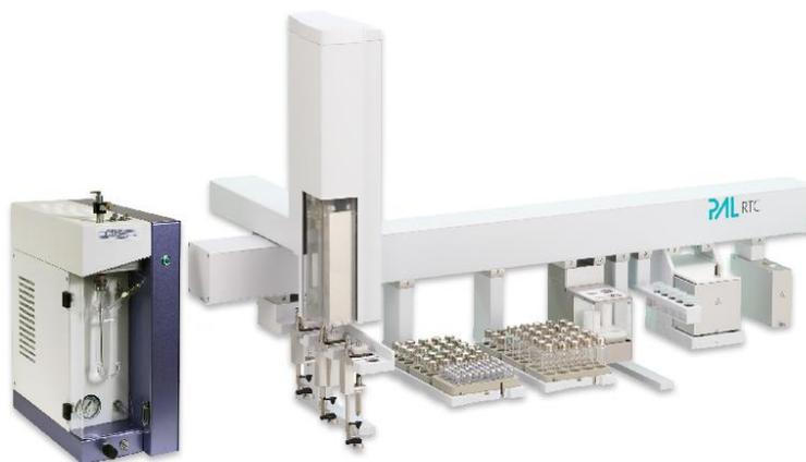
与 Labtech Astation 或 CTC PAL 平台联用的吹扫捕集系统，可完成自动取样，自动吹扫捕集和向 GC/MS 解吸的过程。可完成自动添加内标，自动配制外标，热水清洗吹扫管等操作，该仪器可与动态顶空模块搭配使用，可应用于土壤样品 VOCs 分析等多个领域。
