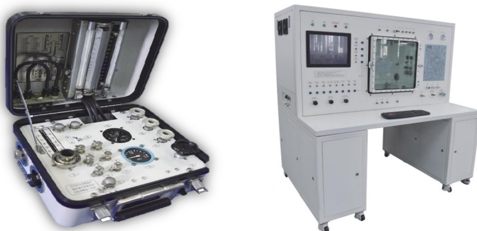
氧气系统地面检测设备
