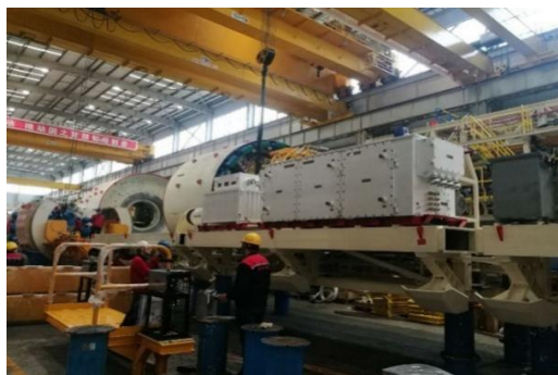
TBM 隧道掘进机
