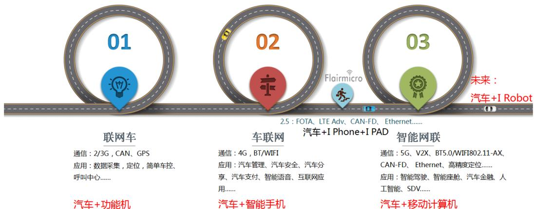
同时，汽车的电子架构也在经历着重大变革，从传统分散式 ECU 向域控制器、多域控制器、云端-本地协同计算架构发展是业界普遍认同的发展趋势，T-BOX 可以看作是信息域，在 T-BOX 基础上扩展到 IVI 及智能驾驶域是一个可能的方向，特斯拉的 Model Y 车型已将通信、IVI、自动驾驶集成到了一个域控制器上，由于我国在通信产业上有一定的优势，从 T-BOX 扩展到 IVI 等其他域更有可能。T-BOX 作为智能网联汽车应用场景实现的重要硬件基础，需提前布设，未来有望成为智能网联汽车标配，率先放量。
