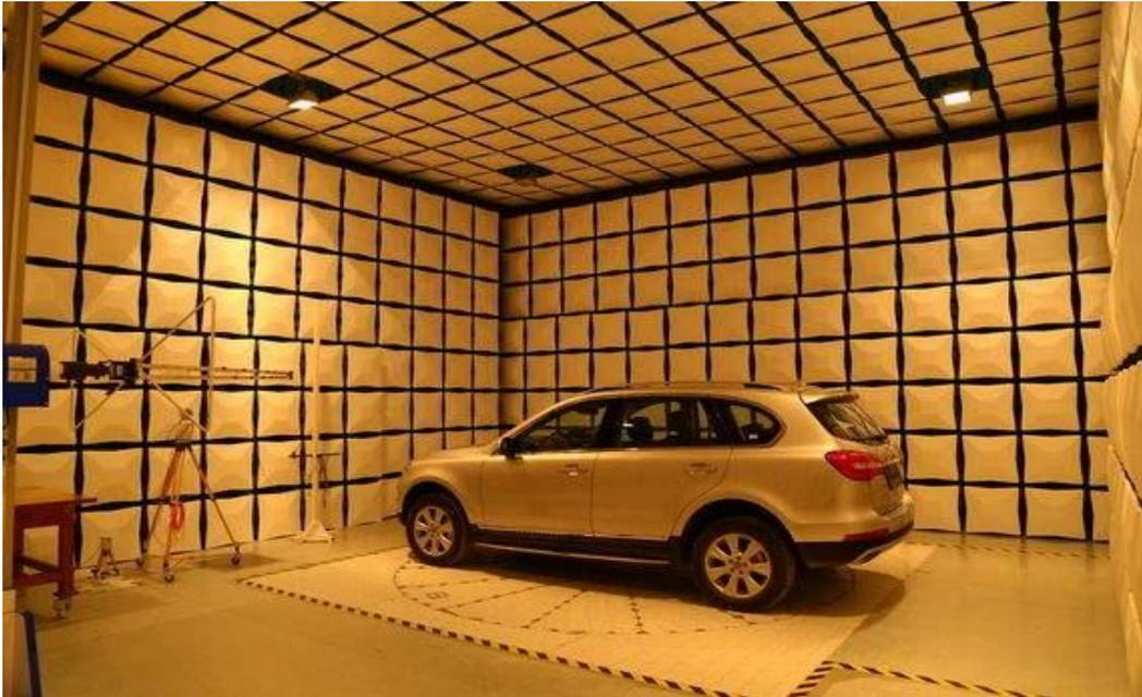
汽车是人类批量生产的最复杂的工业产品之一，是一个由数以万计零部件组成的机电混合复杂系统，每个零部件都需要协调工作。并且，为了规范化汽车这个关乎生命产品的质量，各级政府和汽车制造厂都有严苛的标准体系，以保证汽车的各项功能运转正常，各项指标能够达标。各项要求中与汽车电子产品，特别是车联网通讯产品关系密切的就是汽车电磁兼容性要求。电磁兼容性要求强调通讯在保证稳定可靠的情况下，不能对其他设备工作产生干扰。并且汽车上的静电、火花塞的电磁干扰、发电机的电源波动，甚至汽车行驶到严苛高辐射环境等，这些都在挑战传统的通讯产品。
