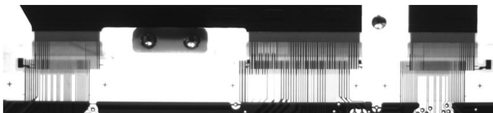
机器视觉下 240mm 以上超长金手指对位示例
