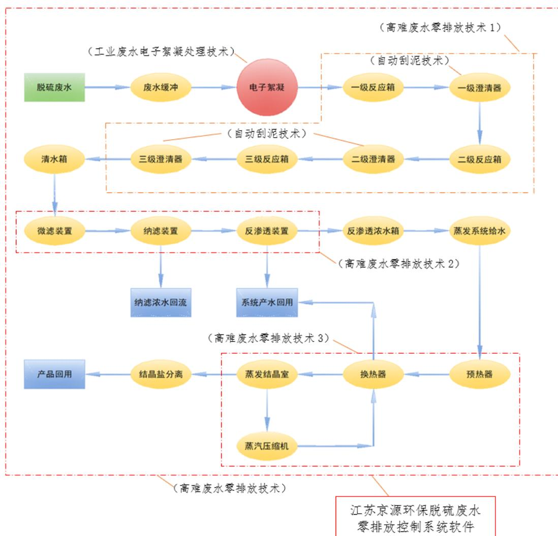
注 1：高难废水零排放技术 1——脱硫废水分泥、分盐零排放预处理技术、副产物实现厂内资源化处置技术。
