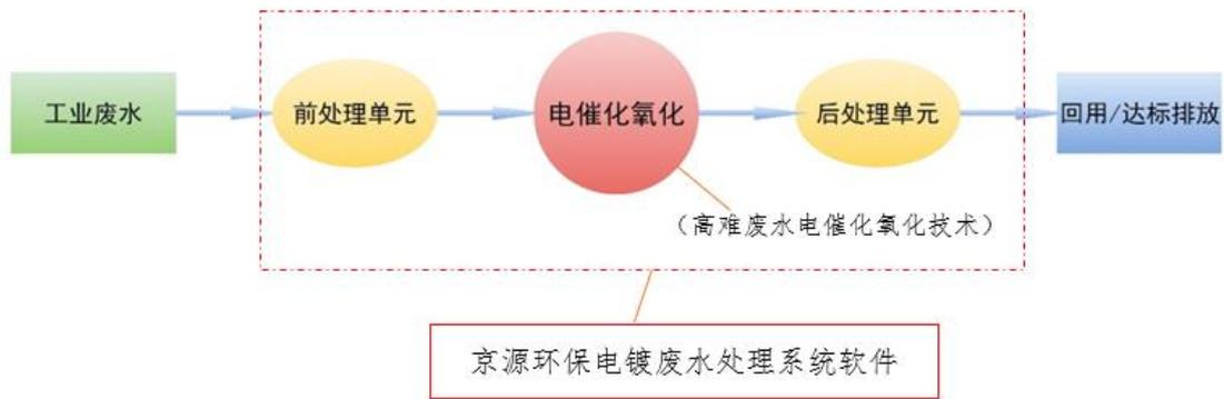
①电镀工业废水首先进入前处理单元，由其对于化学镍废水做悬浮物截留处理，防止污染电极；
