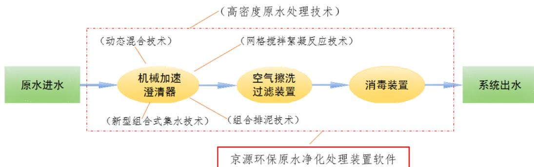
I、原水由泵提升进入机械加速澄清器，经加药动态混合、网格搅拌絮凝反应、沉淀，澄清器底部沉淀污泥经自动刮泥机刮集，通过组合排泥装置排出处置，部分污泥回流至澄清器前端反应区，上清液经新型组合式集水装置收集后进入后续过滤装置；
