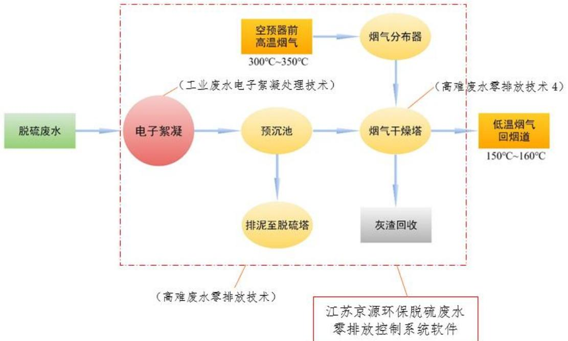
注：高难废水零排放技术 4——高温烟气干燥塔技术。
