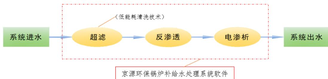
I、经预处理后的来水经给水装置加压后进入超滤系统，经超滤系统处理后出水经给水装置加压进入反渗透系统，进一步处理去除水中杂质；
