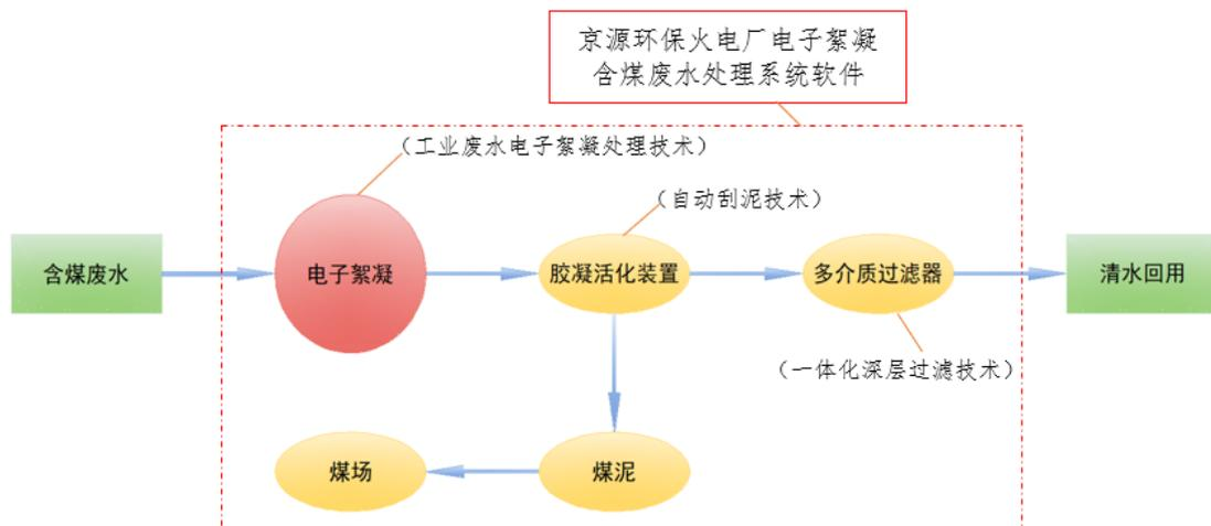
①含煤废水首先由泵进入电子絮凝器，电子絮凝器通过在水中通入电流，以电荷为絮凝辅助介质对含煤废水进行絮凝，从而打破含煤废水中悬浮物的稳定状态；
