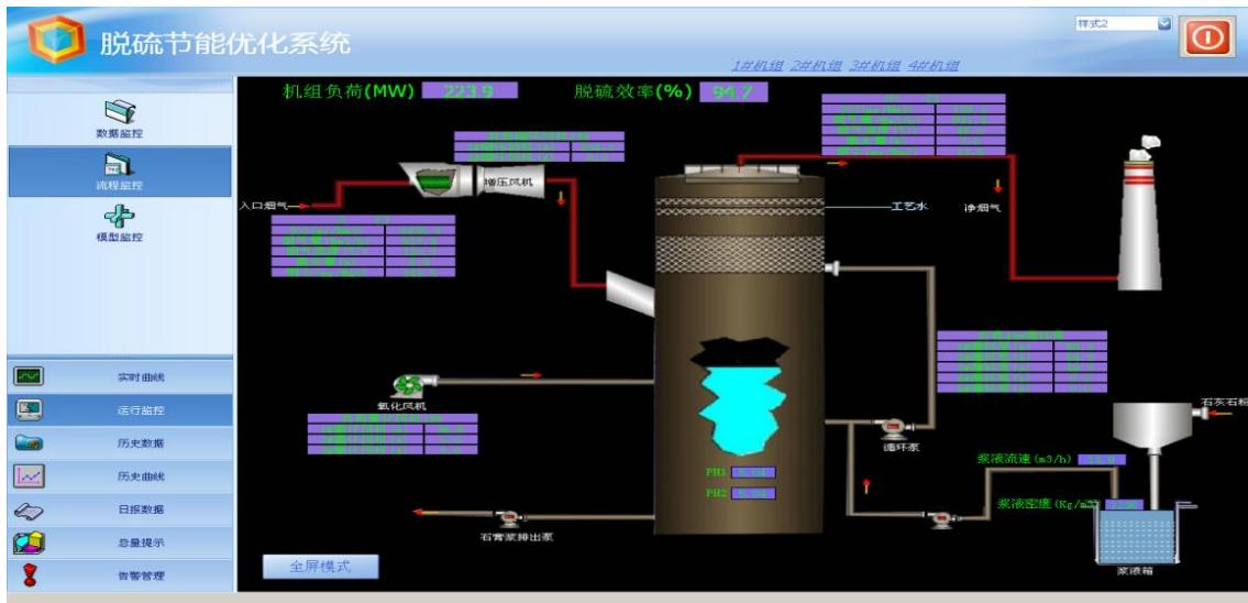
结合物料衡算结果，对上述数据统计形成趋势曲线，并将其与公司建立的工艺模型优化计算出的最佳趋势曲线进行比照和拟合。在实际的业务场景中，例如电厂用于发电的煤炭有时所含硫分较高，导致 SO<sub>2</sub> 和粉尘等污染物的浓度一下子升高很多，传统环保运营中主要靠人的判断，难以对脱硫剂所需的增量进行准确判断，可能导致投放量不足而污染物浓度超标，或是投放过量导致成本浪费；而公司开发的脱硫优化决策支持系统实时输出的脱硫剂投放调整数据能够有效指导运营实践，对脱硫效率形成保障。
