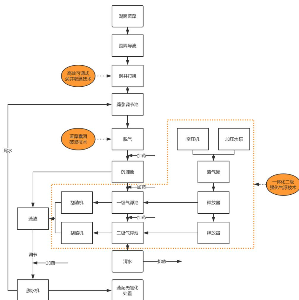
岸上站点藻水分离系统集成在国内首次实现蓝藻治理的工厂化和规模化应用，对大规模蓝藻集中暴发的湖泊水库等水体具有广泛的适用性，是目前蓝藻暴发应急处置的主要手段。该项技术装备的除藻率大于 95%，对于高浓度藻浆，
