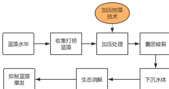
蓝藻加压控藻船可移动，机动性强，可随时到达湖面任一蓝藻聚集位置。其抑藻能力强，到达指定位置后，可立即对漂浮在水面的蓝藻以及混合在水体里的蓝藻进行打捞及加压处理，破坏蓝藻细胞结构，使其被鱼类等浮游生物消耗或死亡后降至湖底，见效快。
