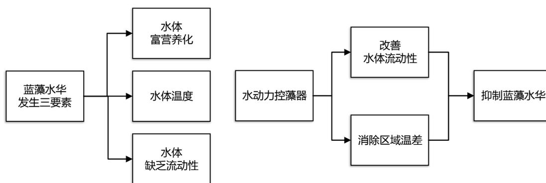
水动力控（灭）藻器对于稀薄、低密度的水华现象具有很好的适用性，不仅可以有效的抑制蓝藻生长，更可以显著的增加水体的溶氧量，是控制蓝藻水华的高效工具。
