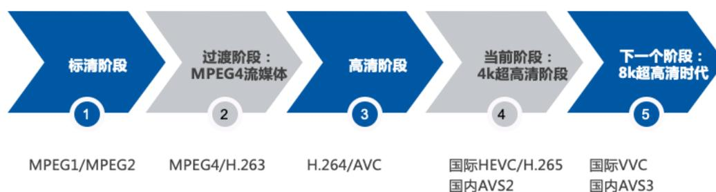
视频编转码的行业发展阶段与信息产业发展紧密相关，而视频是新一代信息网络传输的主要载体，视频处理技术是新一代信息网络的关键技术。其发展过程可以分为若干个阶段，每个阶段针对当时对视频清晰度的需求和硬件能力，制定了不同的视频编码标准，并可大致分为下述几个阶段：
