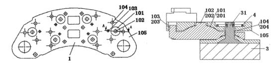
(2)天宜上佳申请的实用新型专利CN206221541U(申请号201621303355.9) 涉及一种列车浮动闸片,包括背板,具有至少一个安装孔;至少一个摩擦结构,通过适于穿过安装孔的铆钉铆接于背板的一侧,并与背板之间形成安装空间,安装空间内设有弹性元件,铆钉包括铆钉杆以及分别连接于铆钉杆的轴向两端的第一铆钉头与第二铆钉头,摩擦结构具有至少一个与安装孔对应设置的摩擦结构通孔,摩擦结构通孔内设有用于限制第一铆钉头朝向背板方向脱出摩擦结构通孔的限位部,第二铆钉头朝向第一铆钉头的端面抵靠于所受背板远离摩擦结构一侧,铆钉杆杆径自第一铆钉头至第二铆钉头逐渐减小形成圆锥杆,铆钉杆的最大外径大于安装孔的内径。闸片结构图如下:
