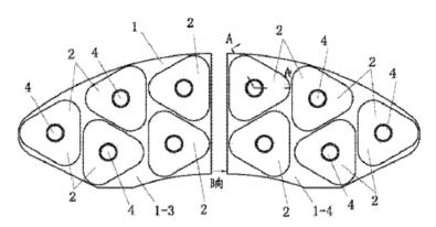
(4) 中国专利文献 CN202301600U(申请号 201120425801.4)公开了一种轨道车辆用制动闸片,包括安装板、燕尾板和若干个摩擦块,燕尾板与安装板的一侧固定连接,每块摩擦块均通过一个连接元件与安装板的另一侧装连,安装板与摩擦块之间(具有若干个弹性元件,弹性元件的一端与摩擦块的底部相抵,另一端与安装板相抵)。闸片结构图如下:
