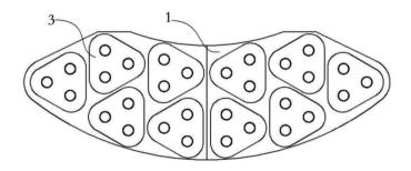
(3) 天宜上佳申请的发明专利 CN103133579A(申请号 CN201310047679) 公开了一种雨雪天气用浮动式制动闸片,属于列车制动技术领域。其包括:背板 (背板为两端通过圆弧过渡的扇环形结构)、若干个摩擦块,摩擦块可浮动地连 接于所述背板上,沿背板的内环至外环排布多层所述摩擦块,相邻层的所述摩擦 块之间设置防转结构,所述摩擦块的摩擦面为一个光整的平面。闸片结构图如下:
