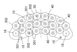
(3)中国专利文献 CN204004093U(申请号 CN201420290153)公开了一种 燕尾通用型制动闸片实用新型专利。闸片结构包括安装板和摩擦块,摩擦块装连 在安装板的一侧,且安装板的另一侧设有燕尾板,所述摩擦块包括摩擦体和背板,摩擦体与背板固定连接,所述安装板与燕尾板制成一体。闸片结构图如下:
