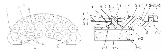
(2)中国专利文献 CN102829106A(申请号 CN201210338669)公开了一种带球形销的制动闸片,其特征在于:它包括一闸片背板、若干闸片摩擦块体、若干三角支撑座、若干定位卡和若干球形销;所述闸片背板采用上、下对称的弧形
