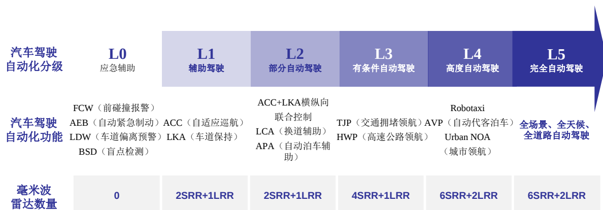
实现不同汽车驾驶自动化等级所需毫米波雷达数量
