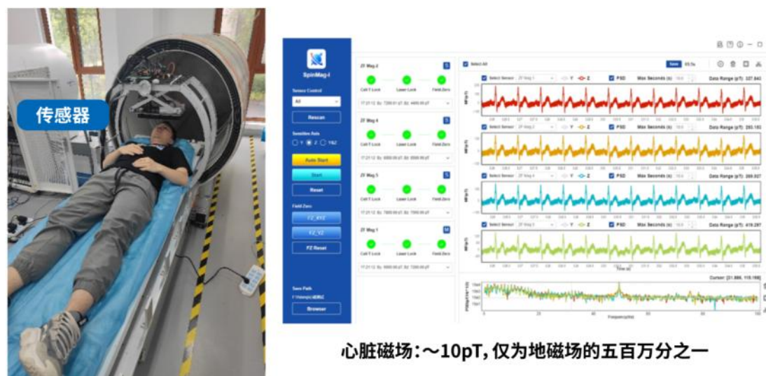
量子自旋磁力仪应用示意图（以检测心脏磁场信号为例）
