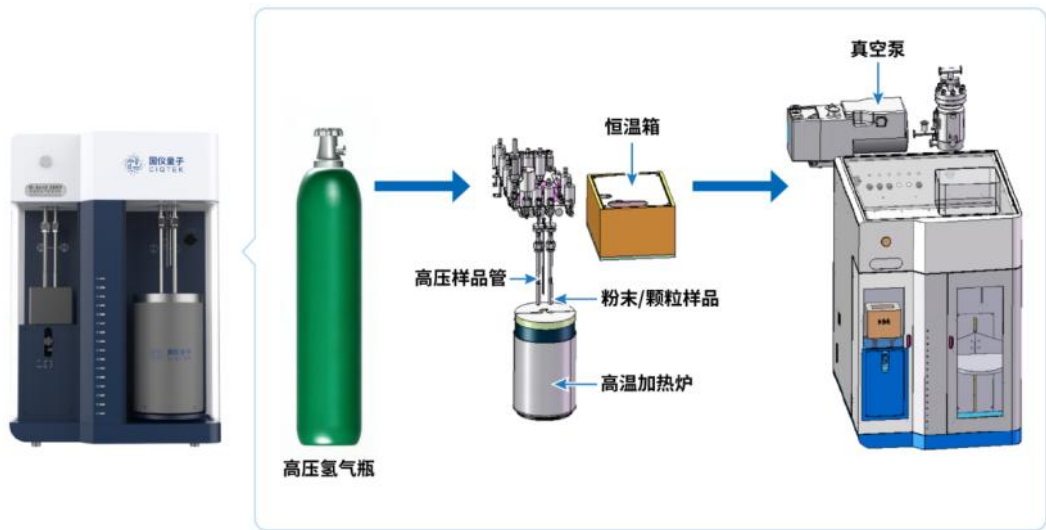
高温高压气体吸附仪结构示意图
