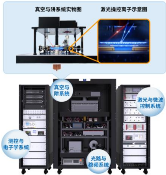
离子阱量子计算机结构示意图
