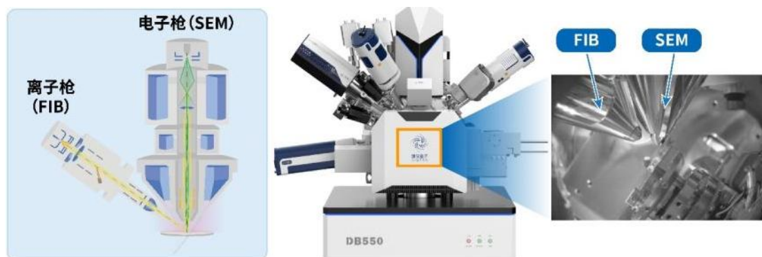
双束电镜结构示意图
