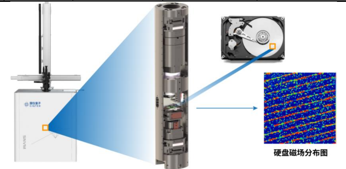
扫描 NV 探针显微镜应用示意图（以获取硬盘磁场分布图为例）
