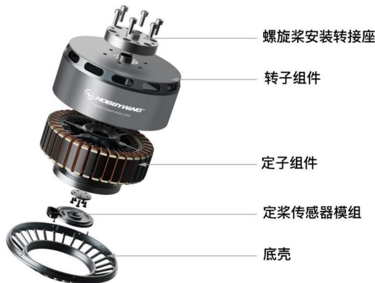
无人机电机示意图
