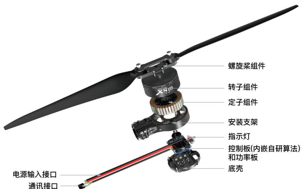
无人机一体化动力系统示意图
