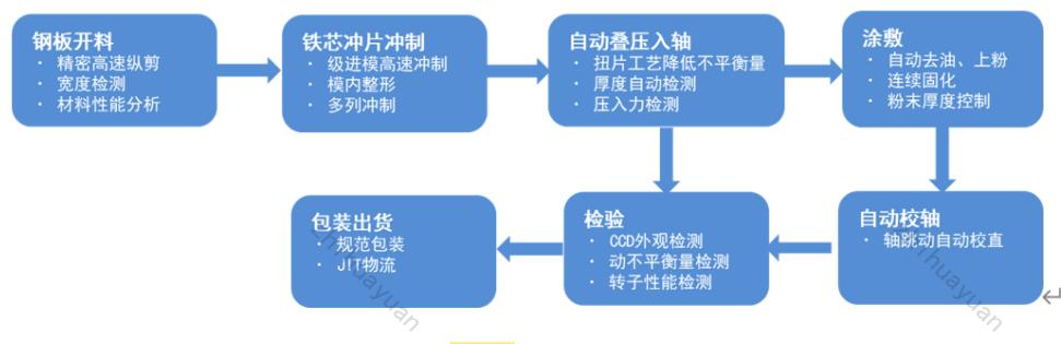
标的公司微特电机转定子铁芯工艺流程图如下：
