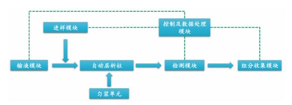
图 5-11 自动层析系统组成示意图
