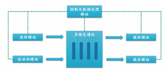
图 5-7 模拟移动床色谱系统组成示意图
