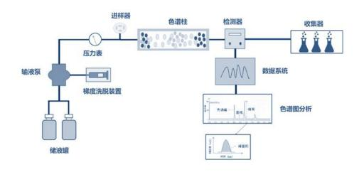
图 5-2 色谱系统构成示意图
