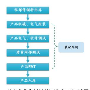
图 5-21 液相色谱系统控制单元生产工序示意图
