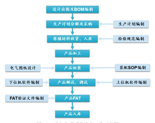
图 5-19 液相色谱系统生产工序示意图
