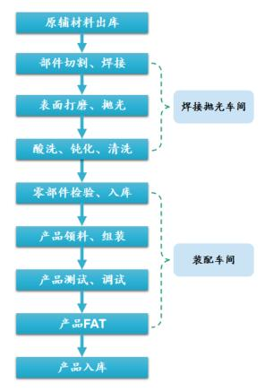
图 5-22 液相色谱系统匀浆单元生产工序图
