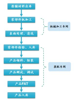
图 5-20 动态轴向压缩柱生产工序示意图
