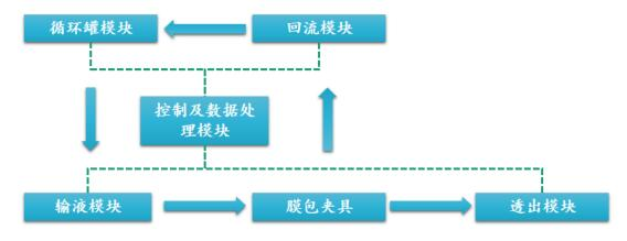
图 5-14 自动超滤系统组成示意图
