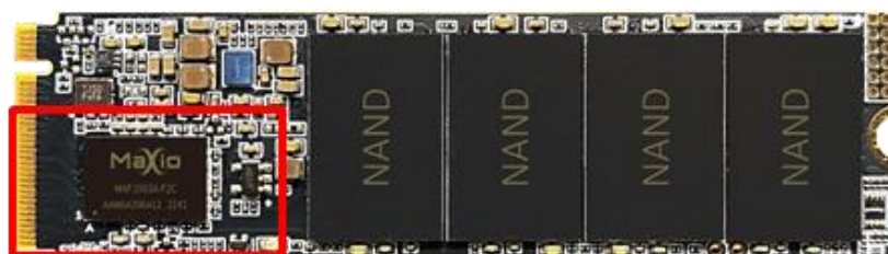
PCIe 接口固态硬盘内部构造图
