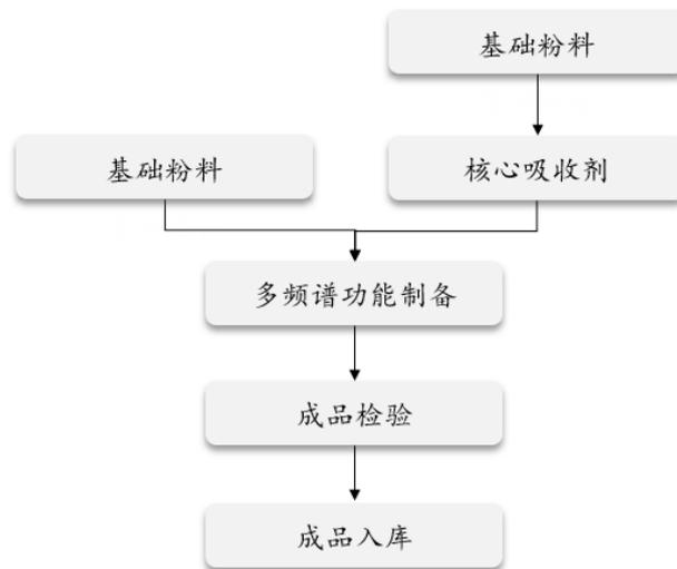
公司购进基础粉料后，部分基础粉料直接用于生产，部分基础粉料经特殊工艺处理后制成核心吸收剂。直接用于生产的基础粉料与核心吸收剂，经添加助剂、辅料、功能胶膜等原材料，再经过特殊工艺处理，制成具备多频谱隐身功能的隐身功能涂层材料产品检验入库。
