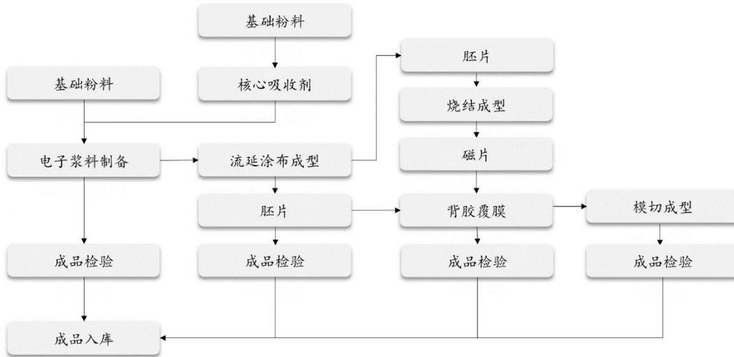
公司购进基础粉料后，部分基础粉料直接用于生产，部分基础粉料经特殊工艺处理后制成核心吸收剂。直接用于生产的基础粉料与核心吸收剂，经添加助剂、辅料等原材料，再经过特殊工艺处理，制成电子浆料。电子浆料可直接通过特殊工艺处理，制成电磁兼容材料产品检验入库；或通过流延工艺制成胚片，胚片再经过特殊工艺处理，可作为电磁兼容材料产品检验入库。胚片经烧结工艺后制成磁片，胚片、磁片与功能胶膜组合，通过覆膜工艺处理，可作为电磁兼容材料产品检验入库；亦可对覆膜后的产品进行模切加工，再作为电磁兼容材料成品检验入库。上述烧结工艺等工艺处理，会使用工装模具等原材料。”
