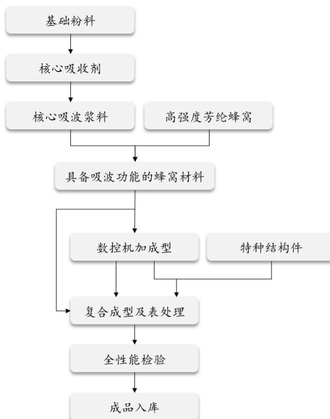
公司购进基础粉料后，先将基础粉料制备成核心吸收剂，再添加助剂、辅料等原材料制成核心吸波浆料。核心吸波浆料和高强度芳纶蜂窝一并经特殊工艺处理后，制成具备吸波功能的蜂窝材料。前述蜂窝材料经过三种不同的生产路径形成隐身功能结构件产品：蜂窝材料结合功能胶膜、工装模具等原材料，通过复合成型及表处理等工艺加工，制成隐身功能结构件产品检验入库；蜂窝材料通过数控机加成型后，结合功能胶膜、工装模具等原材料，再经复合成型及表处理等工艺加工，制成隐身功能结构件产品检验入库；蜂窝材料通过数控机加成型，并与公司采购的作为承载部件使用的特种结构件组合后，再经复合成型及表处理等工艺加工，制成隐身功能结构件产品检验入库。
