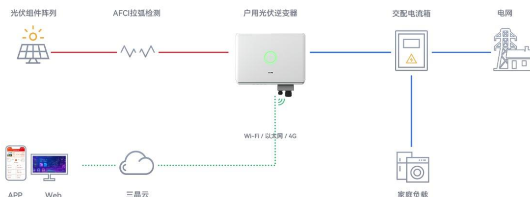
户用光伏并网逆变器系统应用图示
