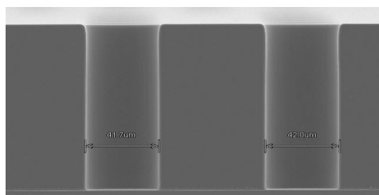
先进封装用g/i线负性光刻胶（110 μm 厚度40 μm孔径）
