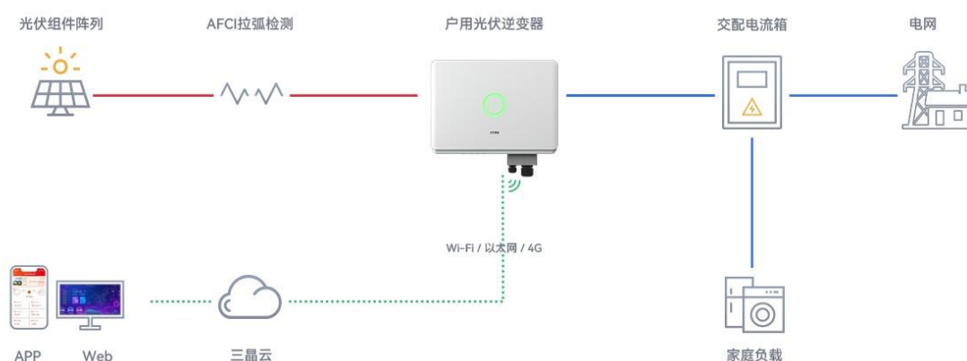
户用光伏并网逆变器系统应用图示
