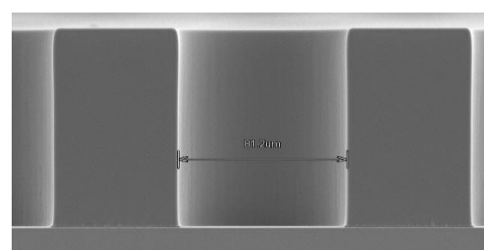
先进封装用g/i线负性光刻胶（110 μm 厚度80 μm孔径）
