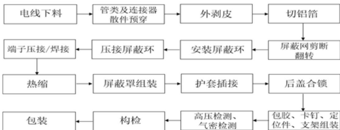
图：汽车高压线束生产工艺流程
