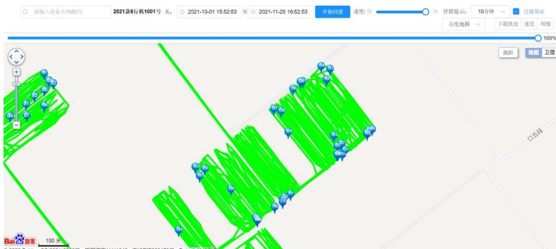
基于此类特征，根据谷米科技提供的定位数据认定每小时内有 20 分钟以上开机时长，偏移距离小于 0.01 经纬度（约 1KM），移动速度低于 10KM/H 的棉花收获机具备棉田作业特征的机器。在上述条件下，取该台棉花收获机该小时内最大经纬度坐标作为该小时内作业特征坐标位置，同一机器相近点位仅保留一条数据。将上述经纬度坐标标记于高德卫星地图上，如落于城市、乡镇街道等非棉田区域则认定为存在非采棉区域作业的可能，标记后的高德卫星地图图例如下：
