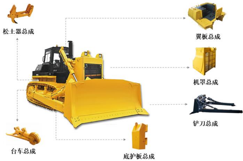
推土机结构件分解图
