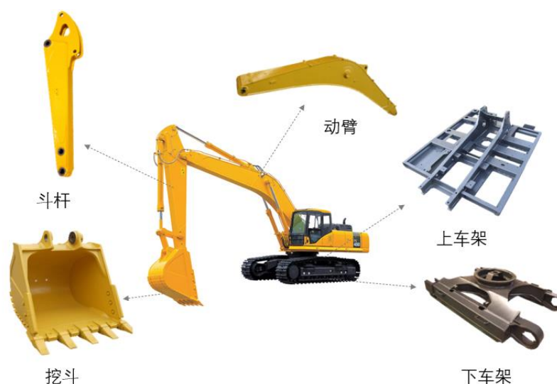
挖掘机械结构件示意图
