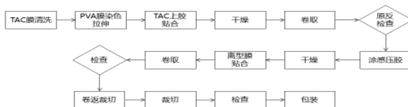
偏光片工艺流程图
