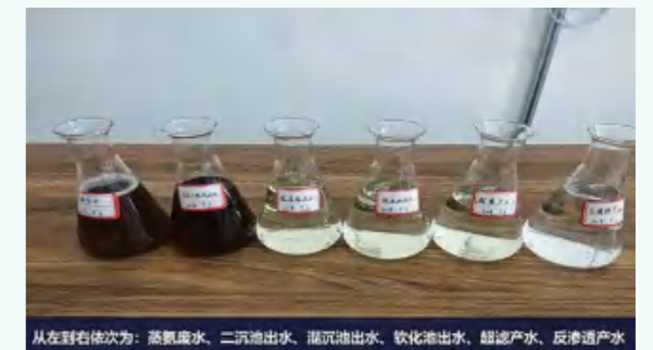
从在到右依次为：蒸氨废水、二沉池出水、湿泥池出水、软化池出水、超滤产水、反渗透产水
