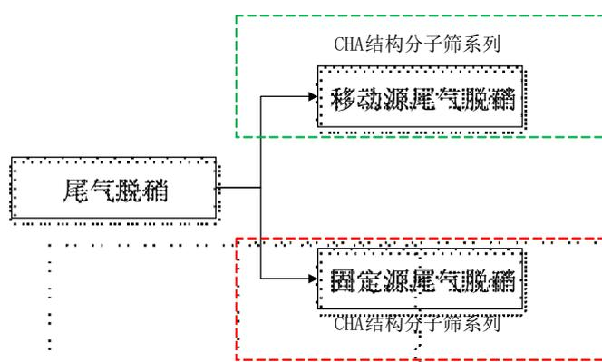
尾气脱硝是指脱除或降低燃料燃烧排放的氮氧化物的过程。目前公司产品主要应用于柴油车等移动源尾气排放的脱硝处理，主要产品类型为 CHA 结构分子筛，可以满足国六阶段排放标准。国六标准是全球范围内最严苛的排放标准之一，进入国六阶段后，国内的排放指标将与欧洲、美国、日本等地区的同级别排放标准相当，部分指标甚至更为严苛。此外，公司已完成针对钢厂、电厂及化工厂等固定源尾气脱硝分子筛的研发及中试工作，已实现工业化应用，主要产品类型为 CHA 结构分子筛等。
