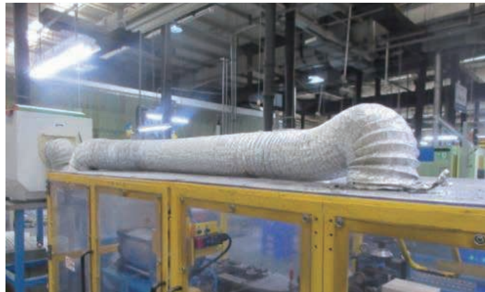
组装机散热片改造
