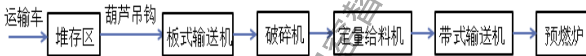
图 2-3 大件垃圾、园林垃圾、生物质垃圾，废轮胎，工业废弃物处置工艺流程
