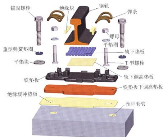
WJ-7型扣件组装零件图
