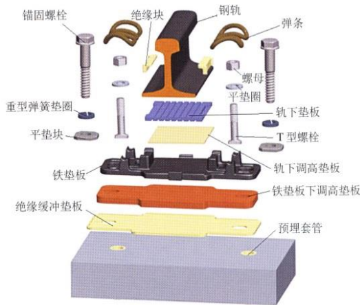
WJ-7型扣件组装零件图
