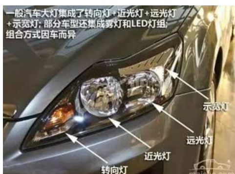
汽车前照大灯构成图示
