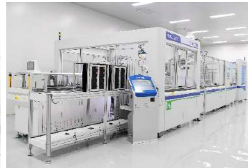
▶ 2019年4月10日，中国西部首条氢燃料电池自动化生产线投产，具备年产1000套氢燃料电池发动机的批量化生产能力，从膜电极、电堆到发动机系统均由东方电气自主开发研制
