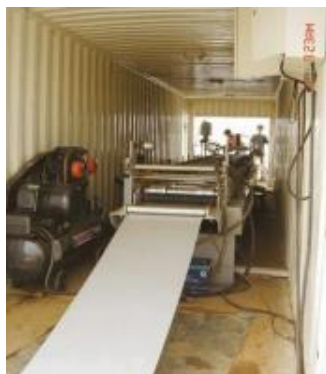
现场生产进料口
