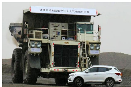
启用多台无人驾驶矿用自卸车，图为遇障碍物紧急制动
