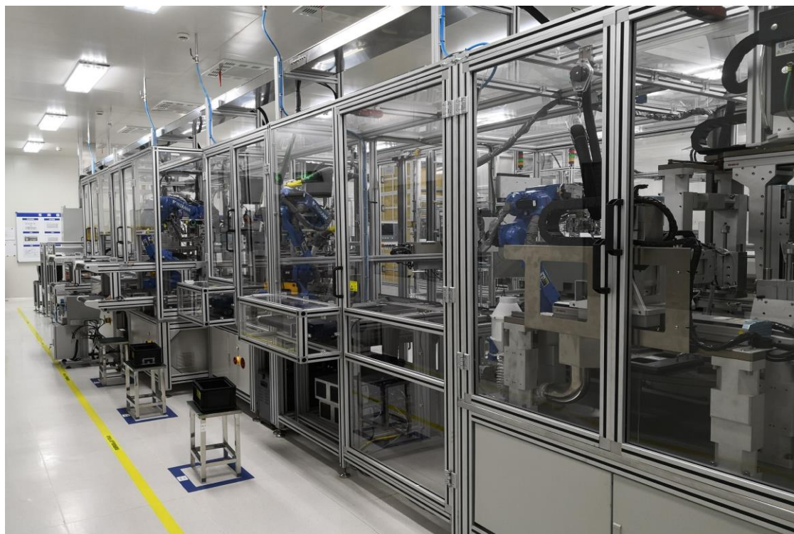
华域汽车电子分公司毫米波雷达自动生产线
