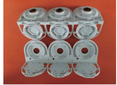
航空器光電吊艙零部件用 鋁合金鑄件製造技術
