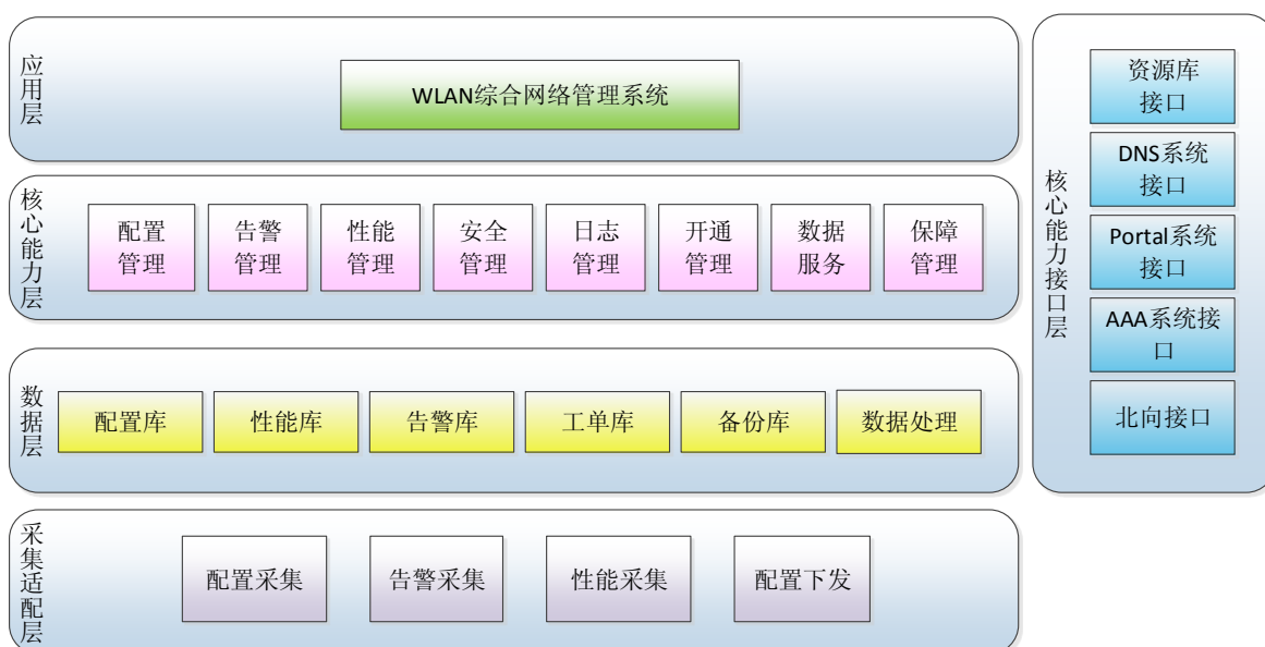
WLAN综合网络管理系统架构图
