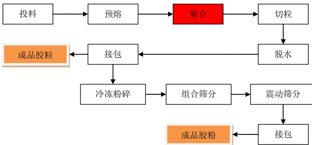
2、PES 热熔胶胶粒、胶粉的工艺流程
