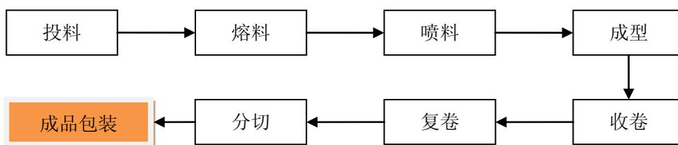
4、热熔墙布的工艺流程
