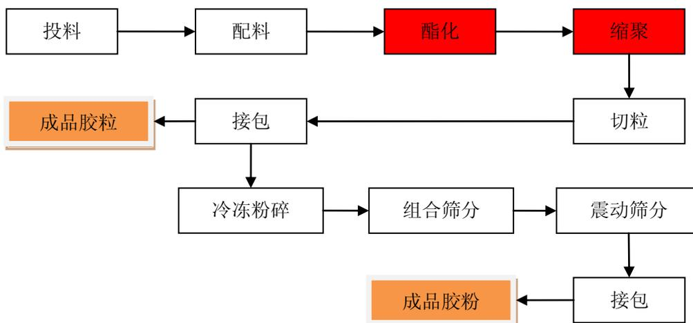
3、热熔胶膜类产品的工艺流程
