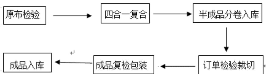
5、反应型胶黏剂的工艺流程
