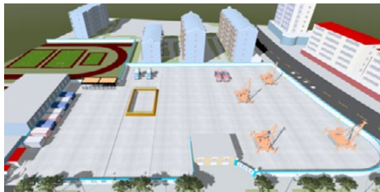
△ BIM 建模, 策划各施工阶段场平布置
